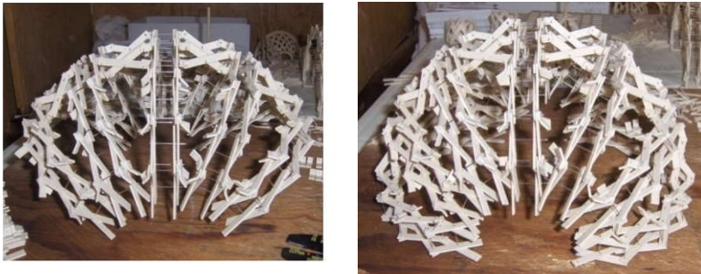
ARRIBA: La figura del armazón puede tener varias formas orgánicas esto pasa por la colocación de los atiesadores que se encuentran en la punta de los arcos, en donde se colocan para definir la geometría de la estructura.
