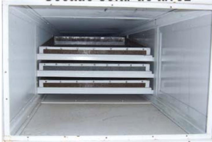
Gabinete o cámara de secado en el deshidratador de arroz del CIE Temixco 2008 [CIE]
