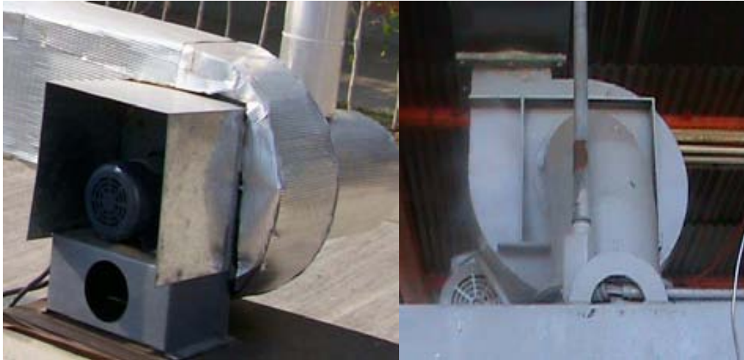
Ventiladores en los deshidratadores del CIE y en Los Azufres 2008 [El autor]
