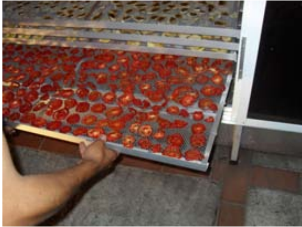
Extracción de la charola para ser pesada.
