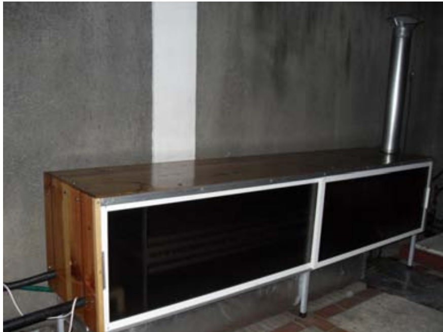
Vista del deshidratador terminado.
