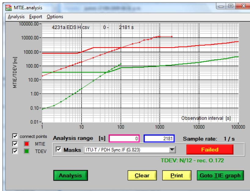
Figura 3.34 Análisis de Conformidad con G.823 del MTIE recibido en el EDS-H.
