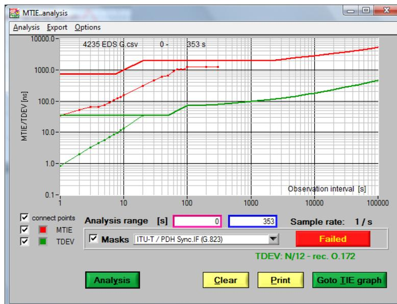
Figura 3.44 Análisis de Conformidad con G.823 del MTIE recibido en el EDS-G.
