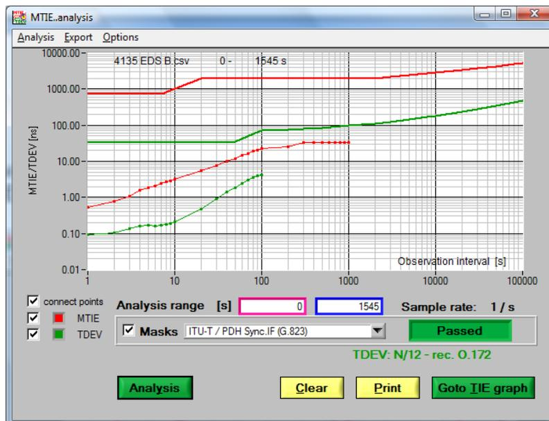
Figura 3.21 Análisis de Conformidad con G.823 del MTIE recibido en el EDS-B.
