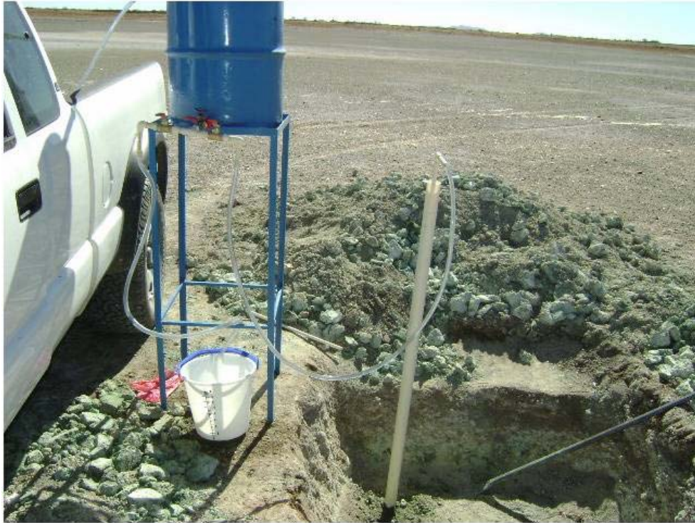
Figura III.10.- Prueba Lefranc carga constante.
