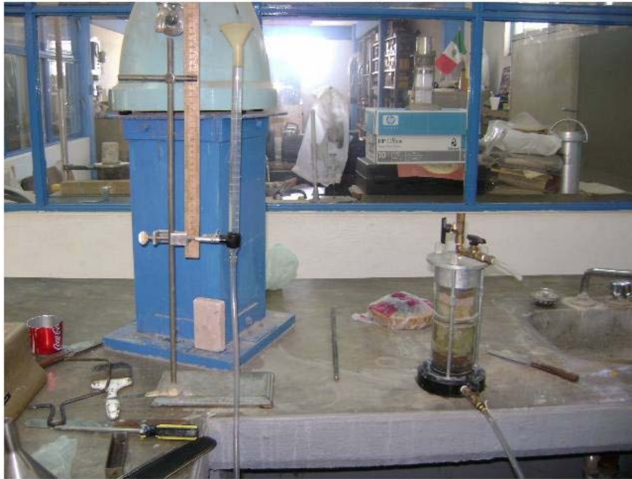
Figura III.13.- Permeámetro de carga variable en muestra inalterada del punto
