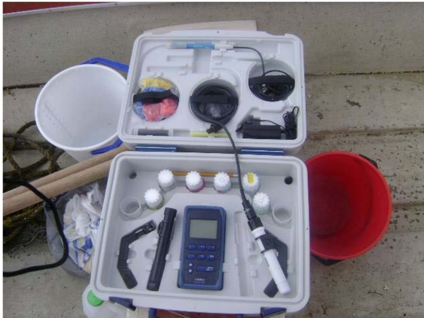
Figura IV.7.- Sonda multiparámetros WTW Multi 350i, utilizada en la medición de parámetros in situ .
