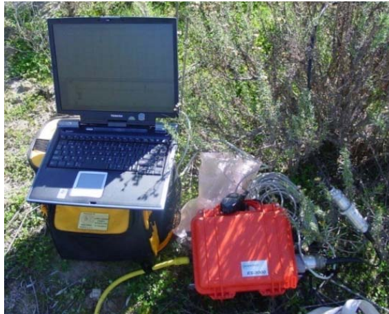
Fotografía 4.1. Sismógrafo ES-3000 y computadora de campo.
