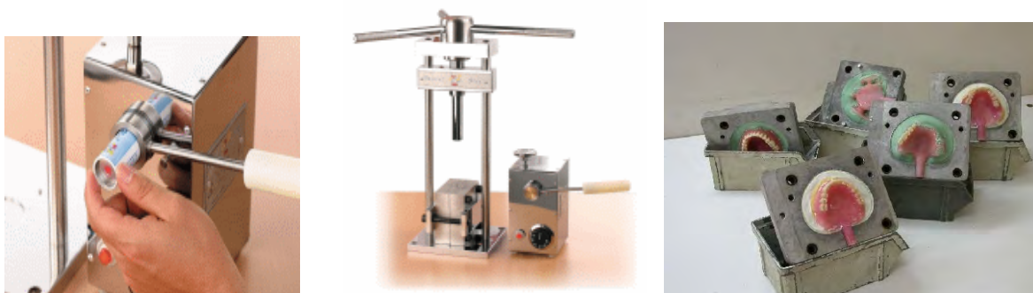
Fig. 15. La imagen muestra el inyectado de la P.P.R. flexible, así como el tubo conector por donde penetra el material a presión.
