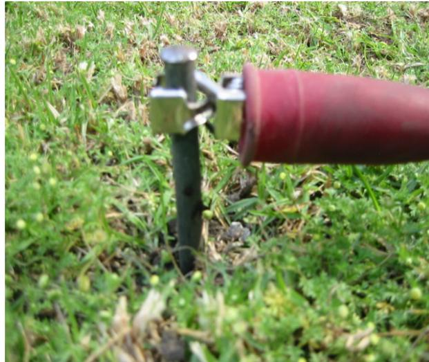
Fig. 1.15b.- Electrodo de prueba y pinza de conexión.
