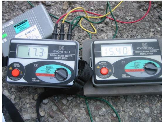
Fig. 7.2.- Equipos de medición de resistencia Mca. Kyoritsu Mod.4105A y 4106A.
