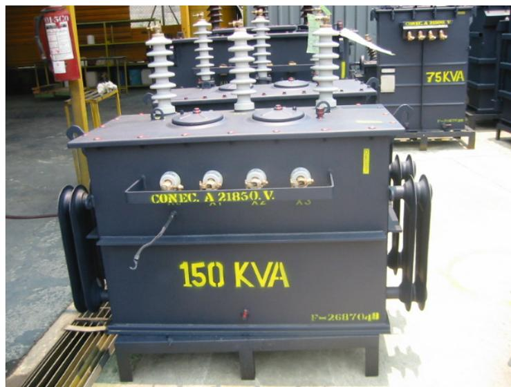
Fig. 5.3.- Transformador 150 [KVA] sumergido en aceite
