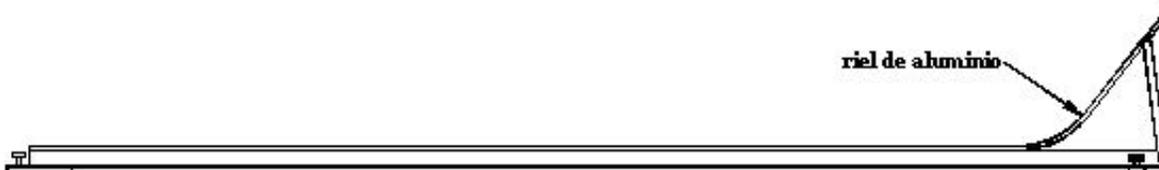
*Figura 3.3 Riel de aluminio con el extremo curvo.*
