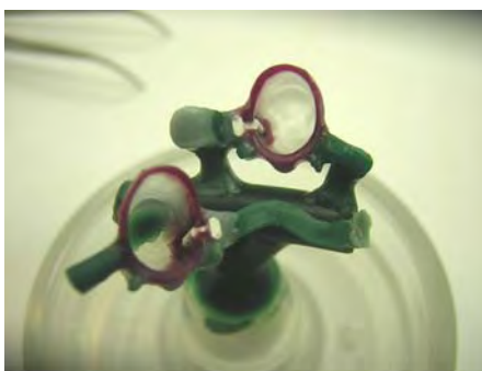
Fig. 54 – Cofias en cera que serán vaciadas en metal.
