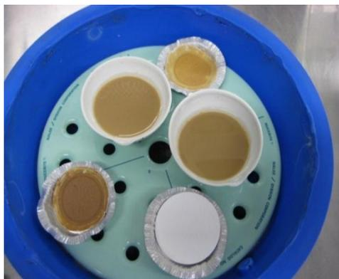
Fotografía 3.11 Filtros y cápsulas con muestra de lodo para SST.
