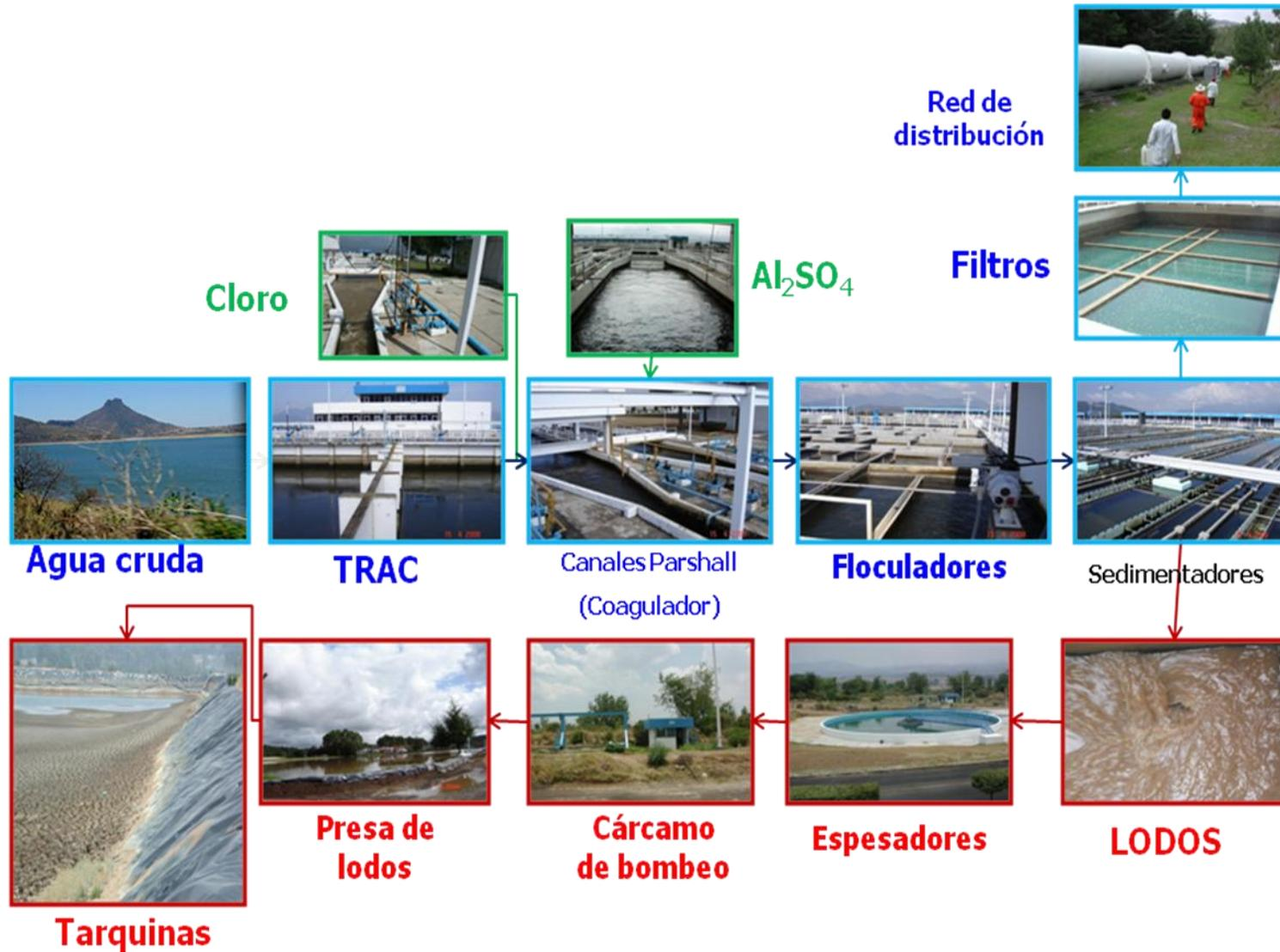
Figura 1. 1 Tren de Tratamiento de la Planta Potabilizadora “Los Berros” (Cerón, 2006).
