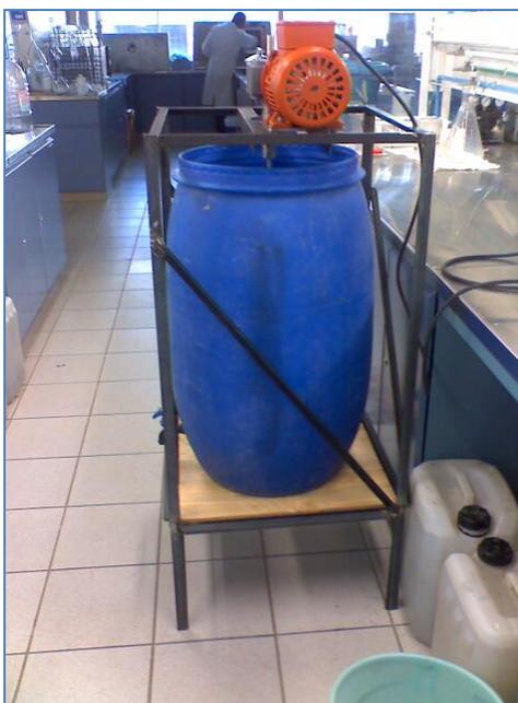
**Figura 3. 3** Equipo piloto empleado para producir los lodos necesarios para las pruebas de espesamiento.
