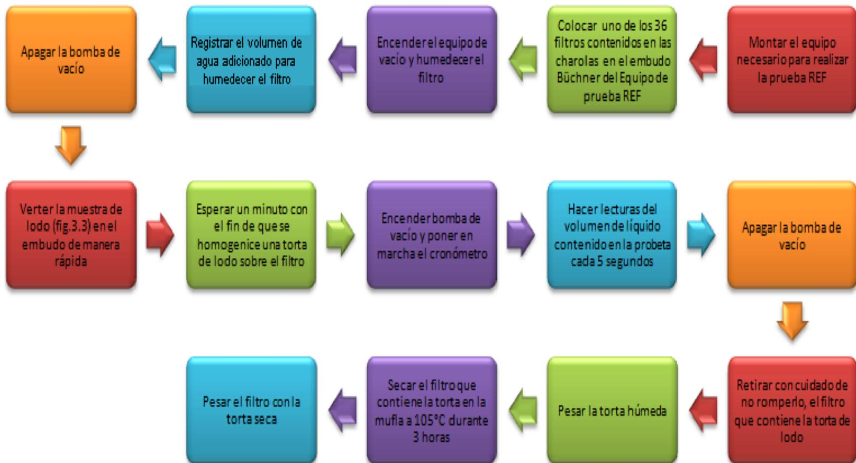
Figura 3. 7 Procedimiento de la prueba de Resistencia Específica a la Filtración (REF) de lodos.
