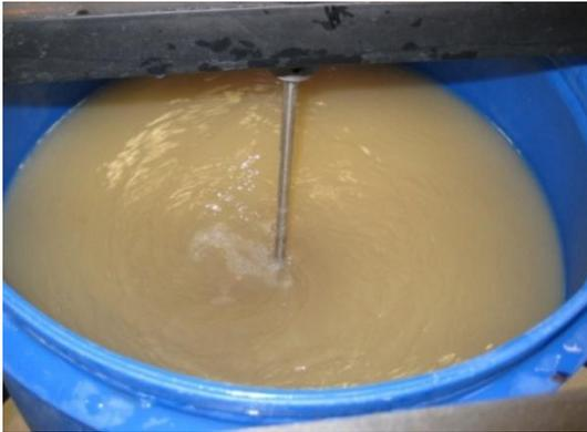
**Fotografía 3.1** Coagulación-floculación para la obtención del lodo.
