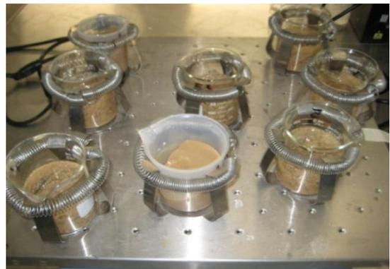
**Fotografía 3.4** Agitación del lodo con espesante
