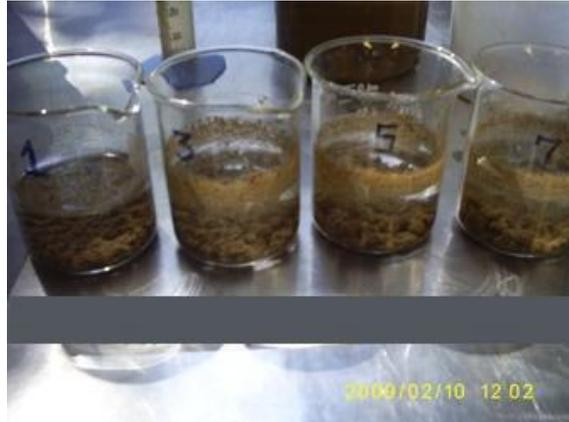
**Fotografía C.22** Lodo obtenido de la combinación Co/FI No.6 espesado con E2 (Copolímero de acrilamida-cloruro de metilo).
