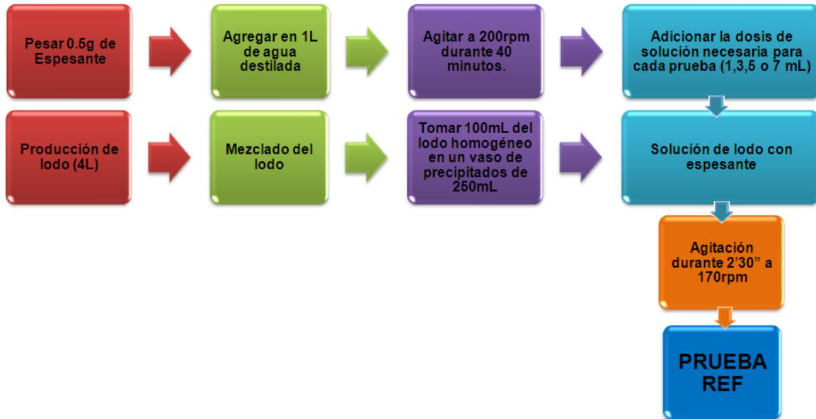
**Figura 3. 4** Técnica experimental de las pruebas de espesamiento de los seis tipos de lodos evaluados.
