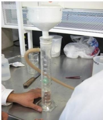
Fotografía 3.9 Medición del volumen de filtrado.
