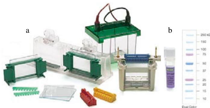
Fig. 4.11 Equipo de electroforesis 1D. a) Equipo para hacer geles de poliacrilamida de 10×10 cm 2 y b) marcador de pesos moleculares.
