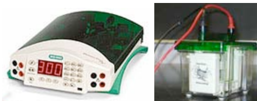
Fig. 4.13 Suministrador de corriente. Colocado el gel en la cámara se conecta al equipo corriendo el gel a 120V.
