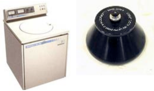
Fig. 4.2 Centrífuga Sorval R5C y rotor SS34. Equipo utilizado para obtener el homogenado de pulmón.
