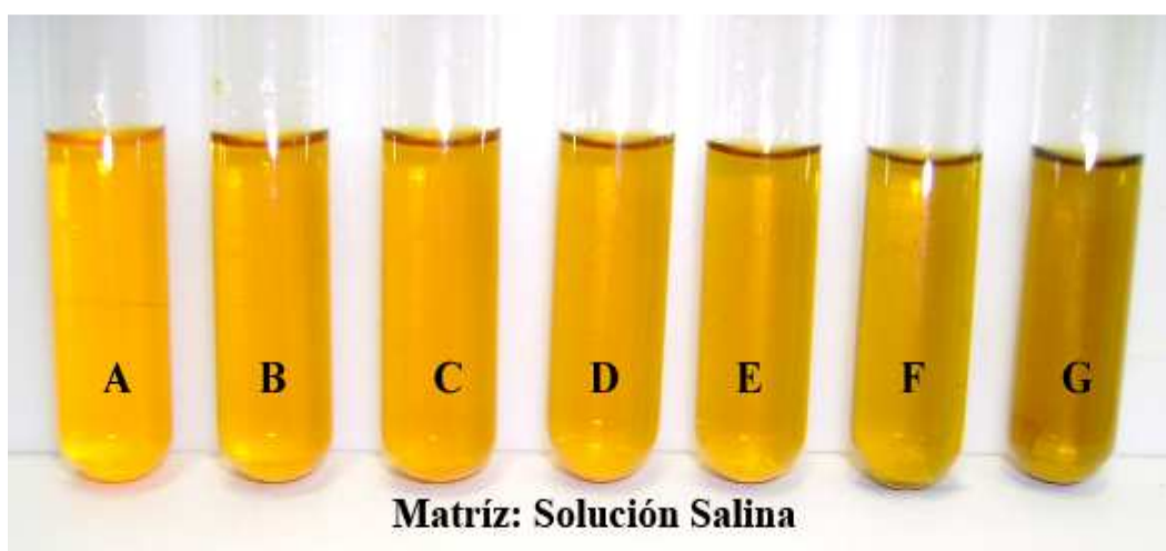
Imagen R6. Tonalidades del Dicromato de Potasio al reaccionar con etanol.
