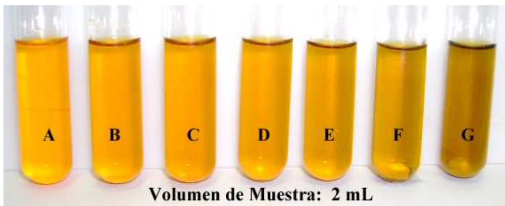
Imagen R11. Tonalidades del Dicromato de Potasio al reaccionar con etanol.
