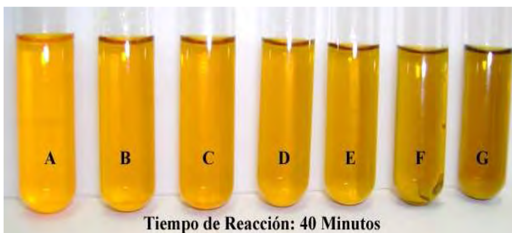
Imagen R8 Tonalidades del Dicromato de Potasio al reaccionar con etanol.
