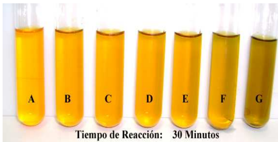
Imagen R7 Tonalidades del Dicromato de Potasio al reaccionar con etanol.
