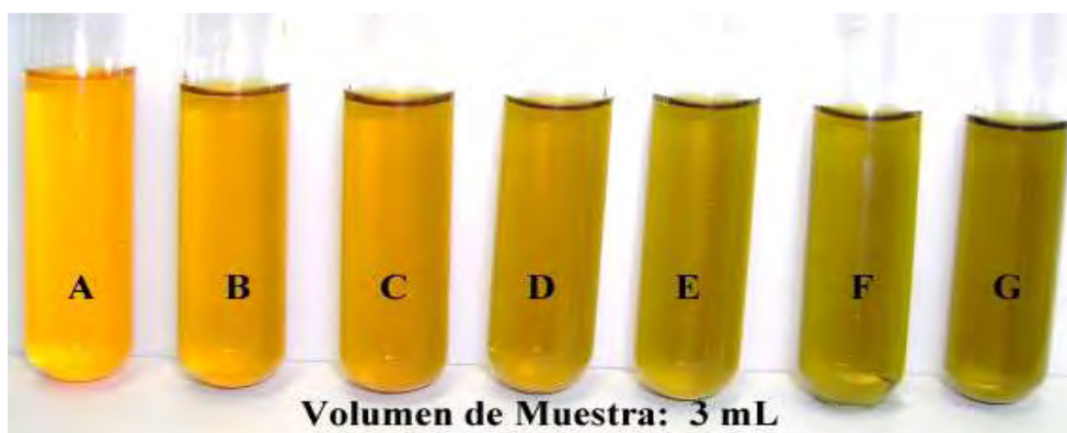
Imagen R12. Tonalidades del Dicromato de Potasio al reaccionar con etanol.
