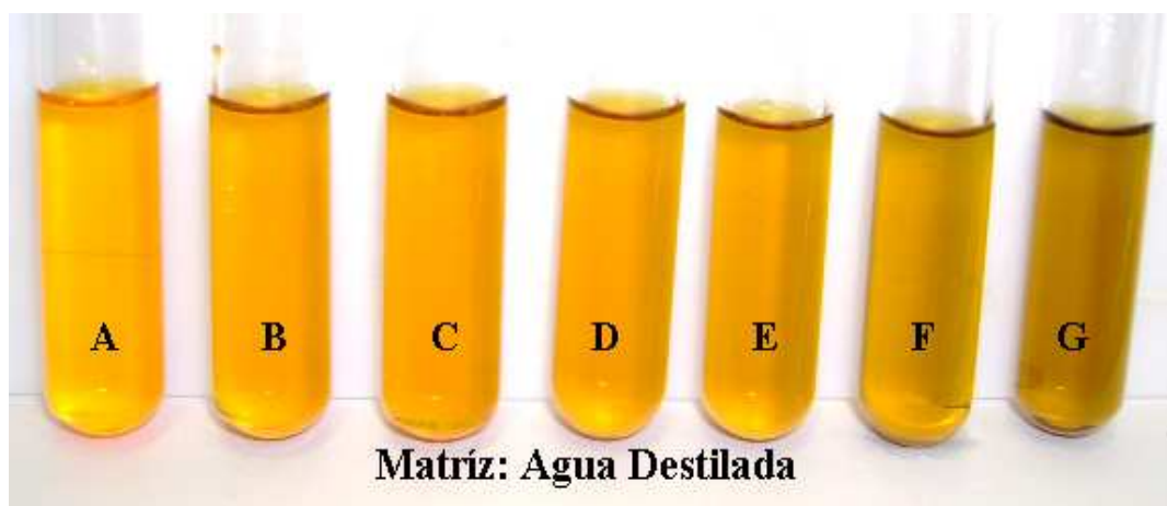
Imagen R5. Tonalidades del Dicromato de Potasio al reaccionar con etanol.
