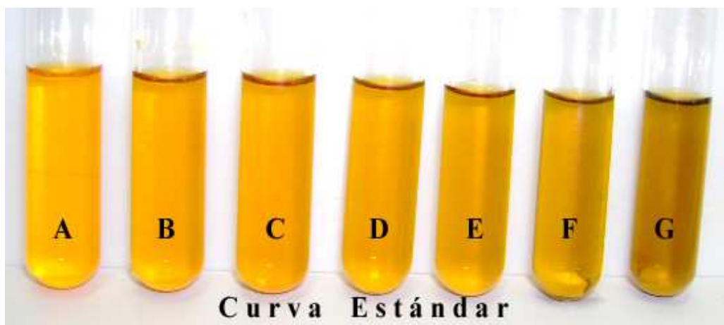
Imagen R13.1 Tonalidades del Dicromato de Potasio al reaccionar con etanol.
