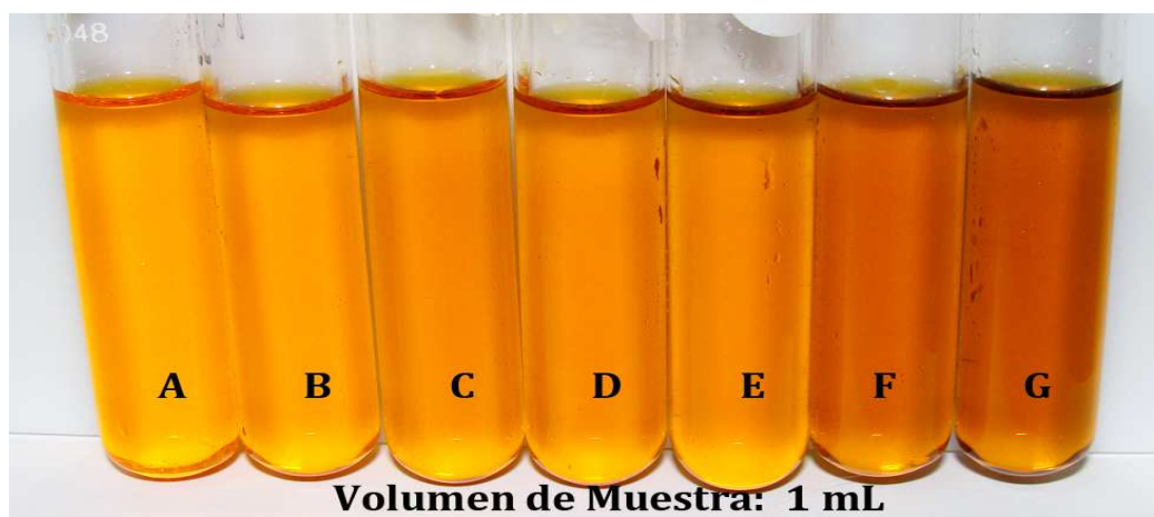
Imagen R10. Tonalidades del Dicromato de Potasio al reaccionar con etanol.
