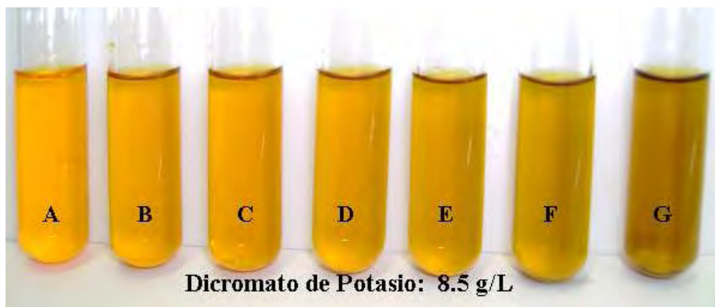
Imagen R4 Tonalidades del Dicromato de Potasio al reaccionar con etanol.
