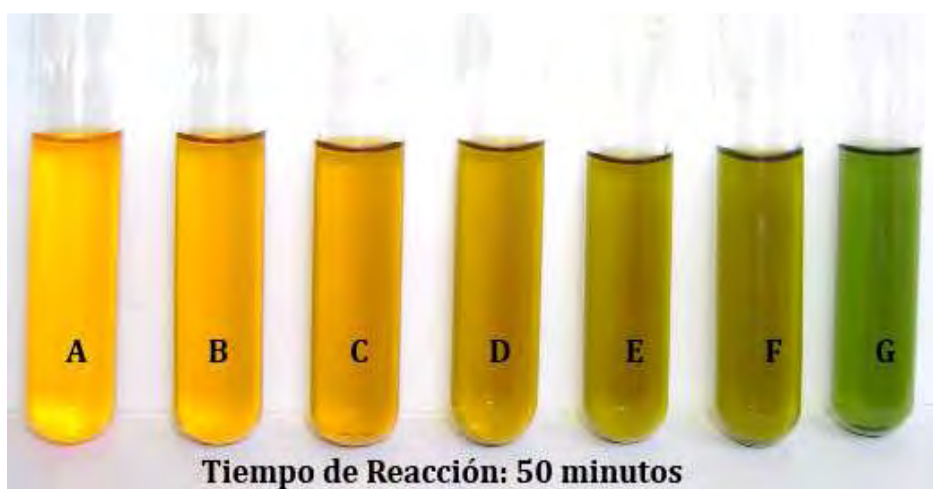
Imagen R9.1 Tonalidades del Dicromato de Potasio al reaccionar con etanol.
