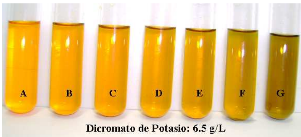
Imagen R3 Tonalidades del Dicromato de Potasio al reaccionar con etanol.
