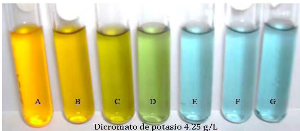
Imagen R2. Tonalidades del Dicromato de Potasio al reaccionar con etanol.
