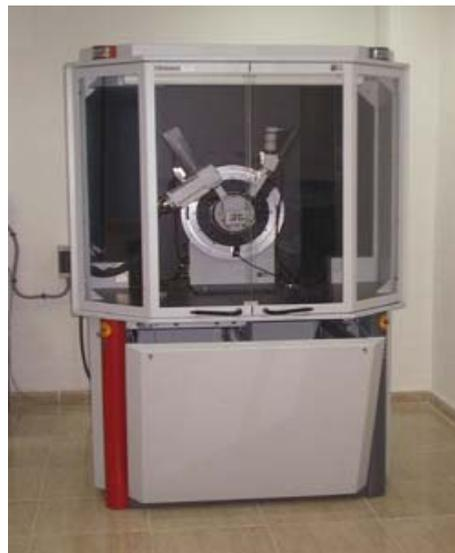
*Figura 2.3 Difractometro BRUKER D8 Advance.*
