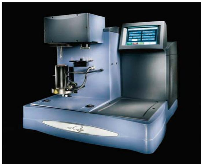
Figura 2.5 Equipo de análisis termogravimétrico.
