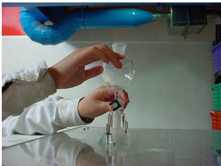
**Figura 3.14. Apertura del embudo para ingresar las soluciones a la columna de separación**
