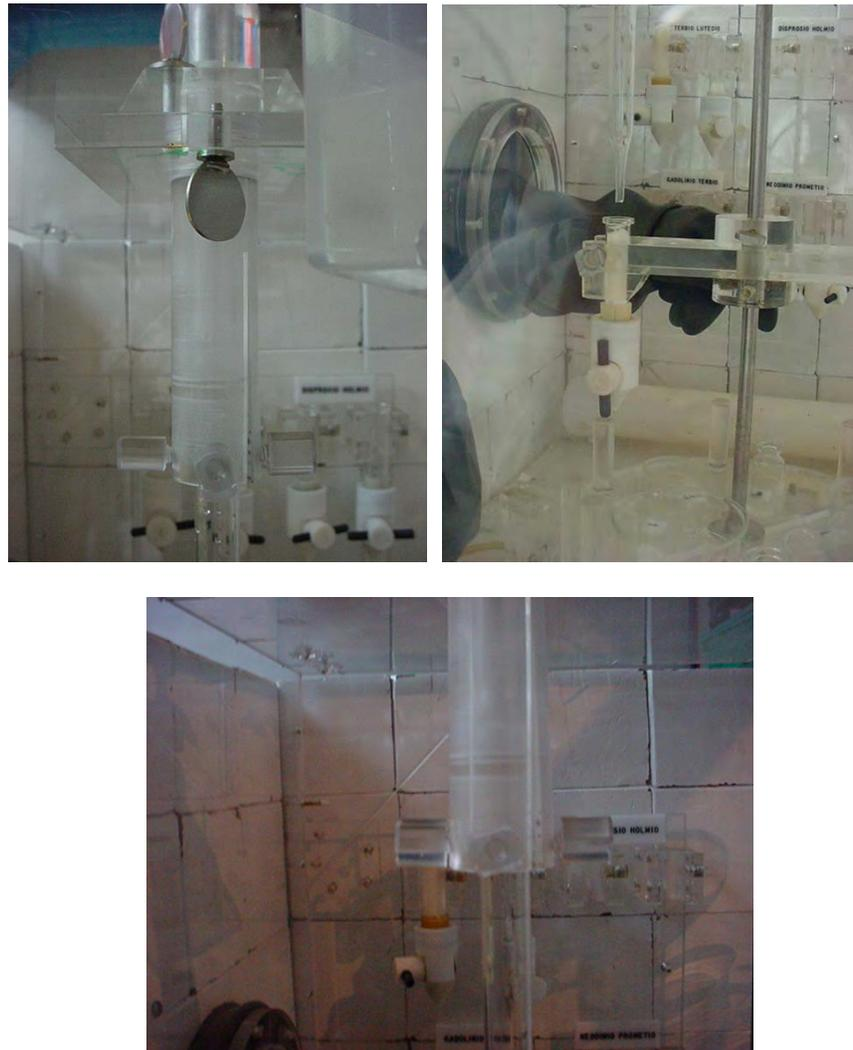
Figura 2.25. Sujetador de acrílico y adaptador de vidrio
