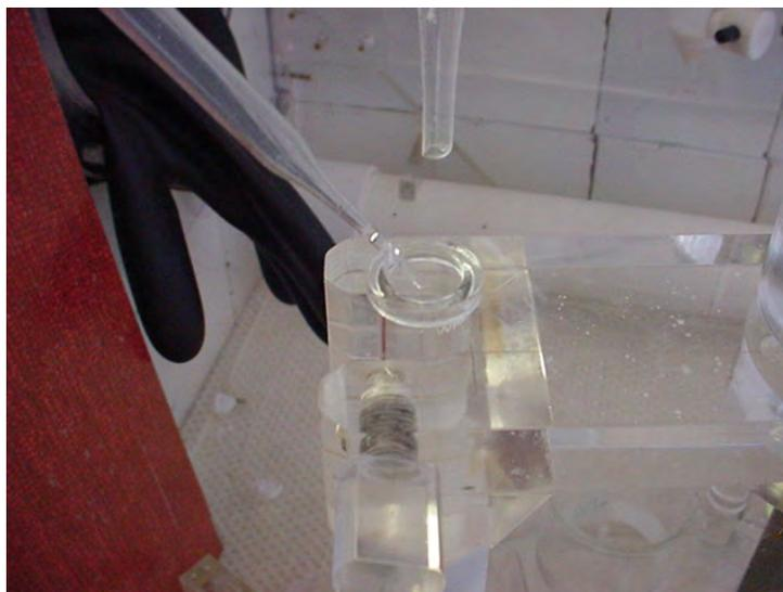
**Figura 3.13. Introducción de la solución radiactiva a la columna de separación.**
