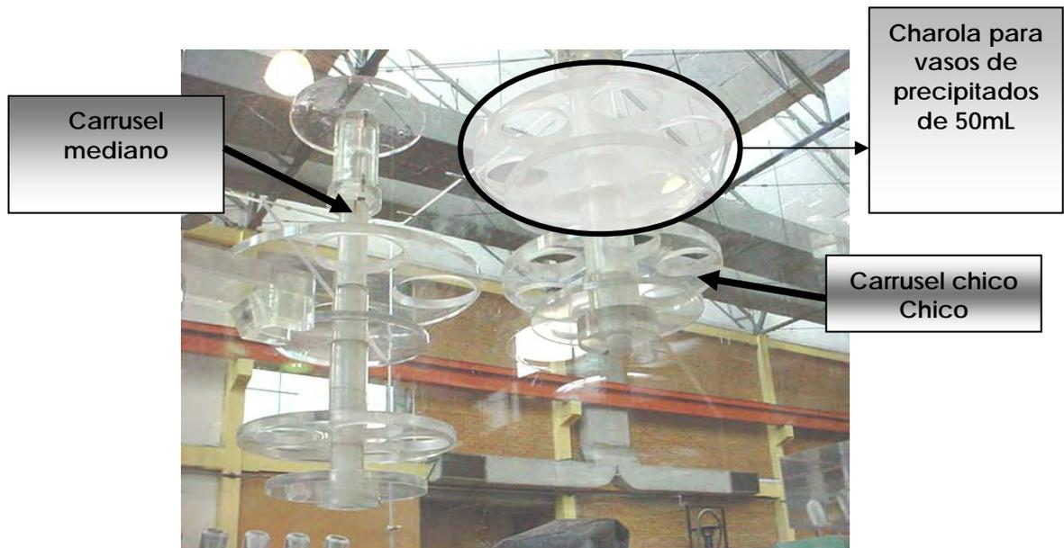
Figura 2.17. Montaje de los porta vasos en la pared superior de la celda y charola para vasos de precipitados de 50mL
