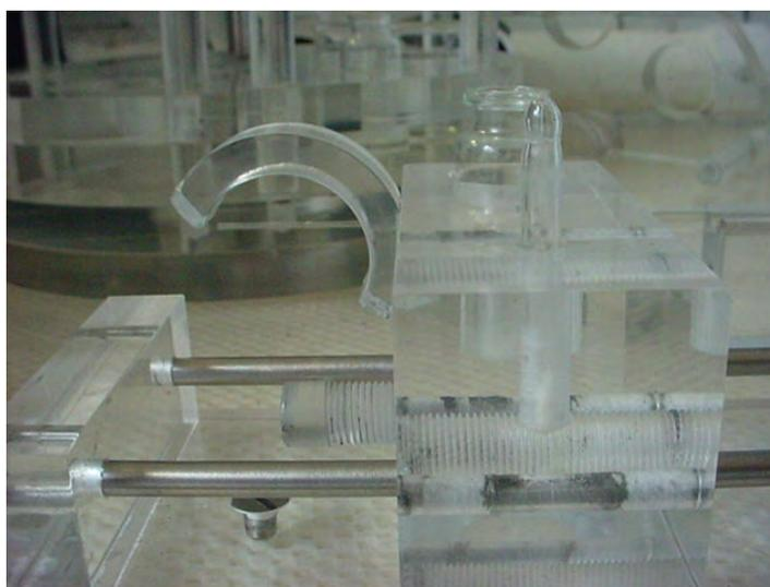
**Figura 2.43. Ejes de desplazamiento y soporte de ampollita de cuarzo y frasco de solución radiactiva**
