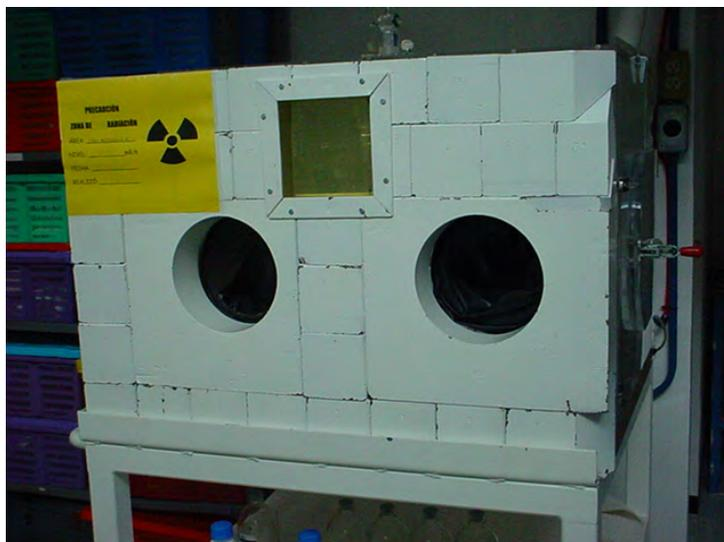
Figura 2.46. Pared frontal de blindaje de Plomo
