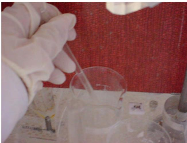
Figura 3.18. Precipitación de  $^{161}\text{Tb}$  adicionando NaOH a la solución de nitratos.
