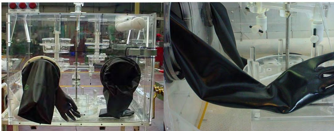
Figura 2.49. Guantes de neopreno colocados fuera y dentro de la celda caliente
