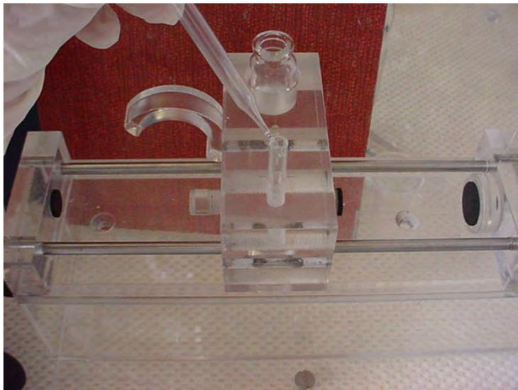
Figura 3.12. Disolución del nitrato radiactivo con  $\text{HNO}_3$  0.15 mol/L
