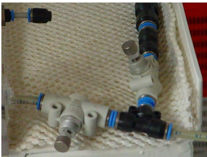
Figura 2.10. Accesorios empleados en el sistema de aire
