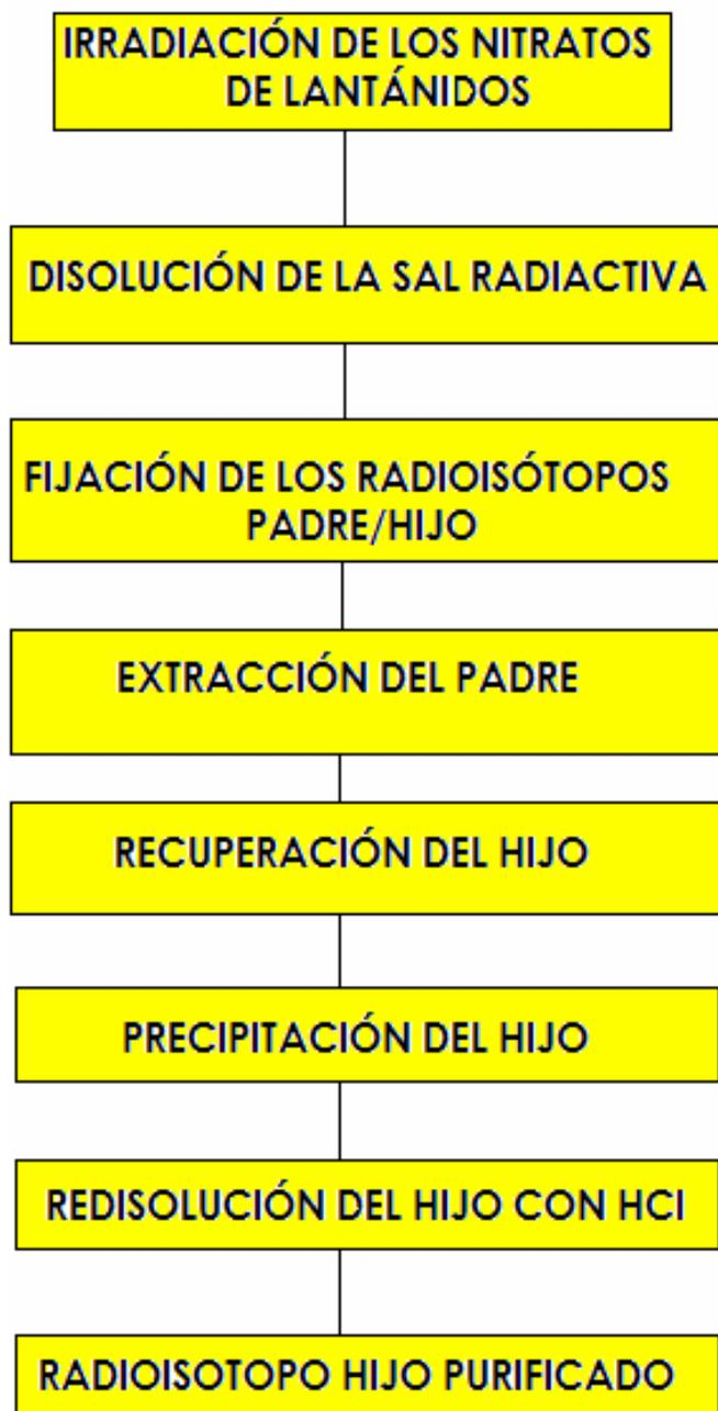
Figura 2.1. Metodología de Producción de los Radioisótopos:
