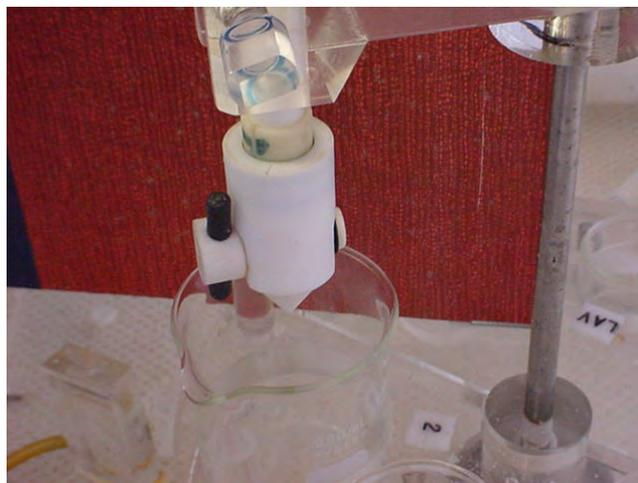
Figura 3.16. Recolección del radioisótopo padre en el vaso de precipitado No.2
