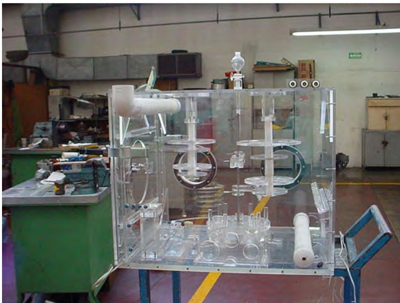
Figura 2.13. Componentes fijos a la pared superior de la celda del DISER.
