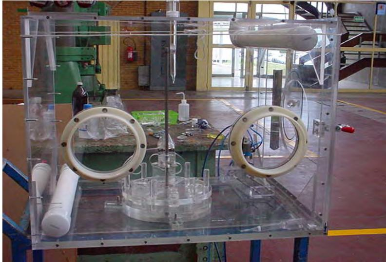
Figura 2.3. Celda caliente
