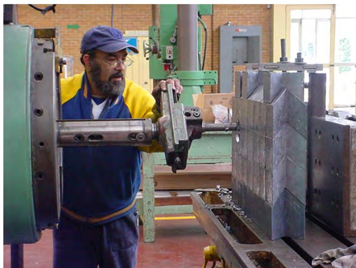
Figura 2.47. Fabricación de los bloques de plomo en el ININ
