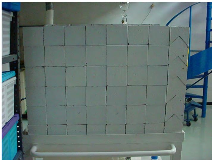
Figura 2.48. Pared lateral izquierda de Plomo
