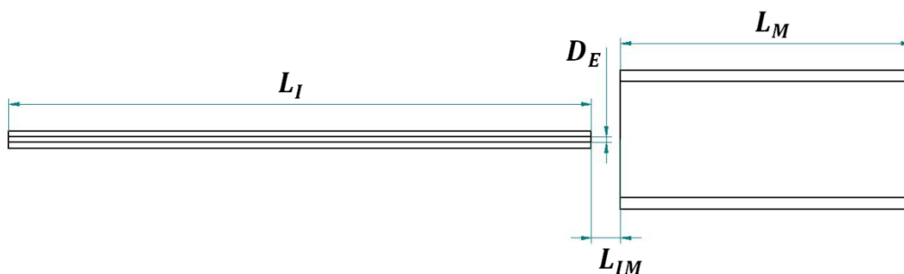
Figura 4.6 Medidas para el arreglo del mezclador.
