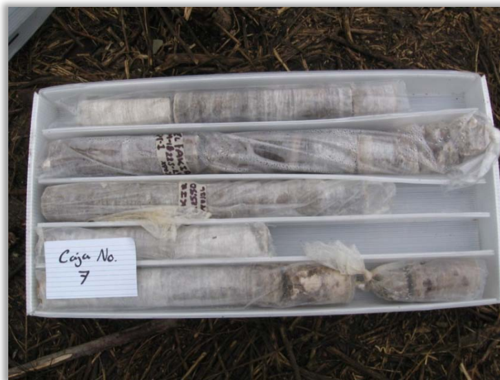
Fotografía 4. Recolección y control de muestras en caja portanúcleos.
