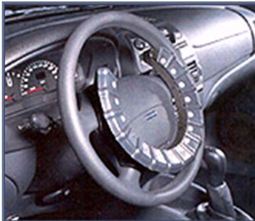
Figura 6. Aro de aceleración con diversas posiciones para facilitar la aceleración.
