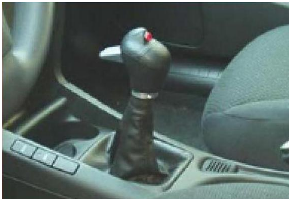
Figura 10. Palanca de velocidades con un accionamiento al sistema de embrague.
