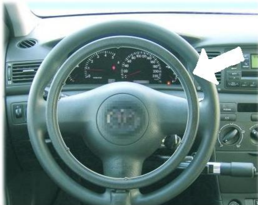
Figura 3. Este es el aro que se utiliza para acelerar. Algunos están acoplados por palancas al acelerador y otros utilizan telemandos a sistemas acoplados electrónicamente.
