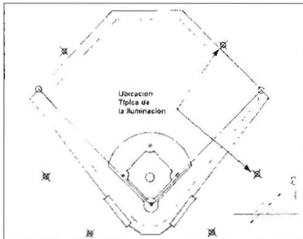
Esquema para la colocación de la iluminación
