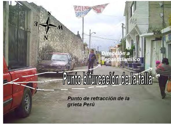
Figura 56. Bifurcación de la falla, muestra la inclinación del terreno.
