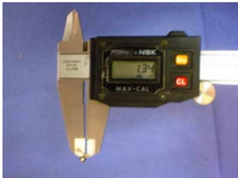
Fig. 6 Se midieron todos los diámetros mayores y menores de las porciones de ambas marcas de postes de fibra de vidrio
