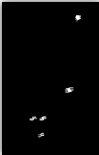
Figura. 17. Imagen binaria, resaltante de la aplicación del umbral, con entrelazado en los puntos de interés.
