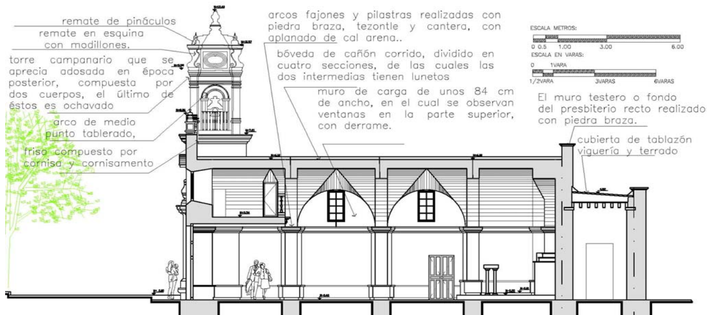
Plano número 51. Corte longitudinal de la capilla de Santa Cruzita y sus componentes. Dibujo, levantamiento y análisis de DRLT, 2009.
