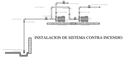
SISTEMA HIDRONEUMATICO (ALZADO)
