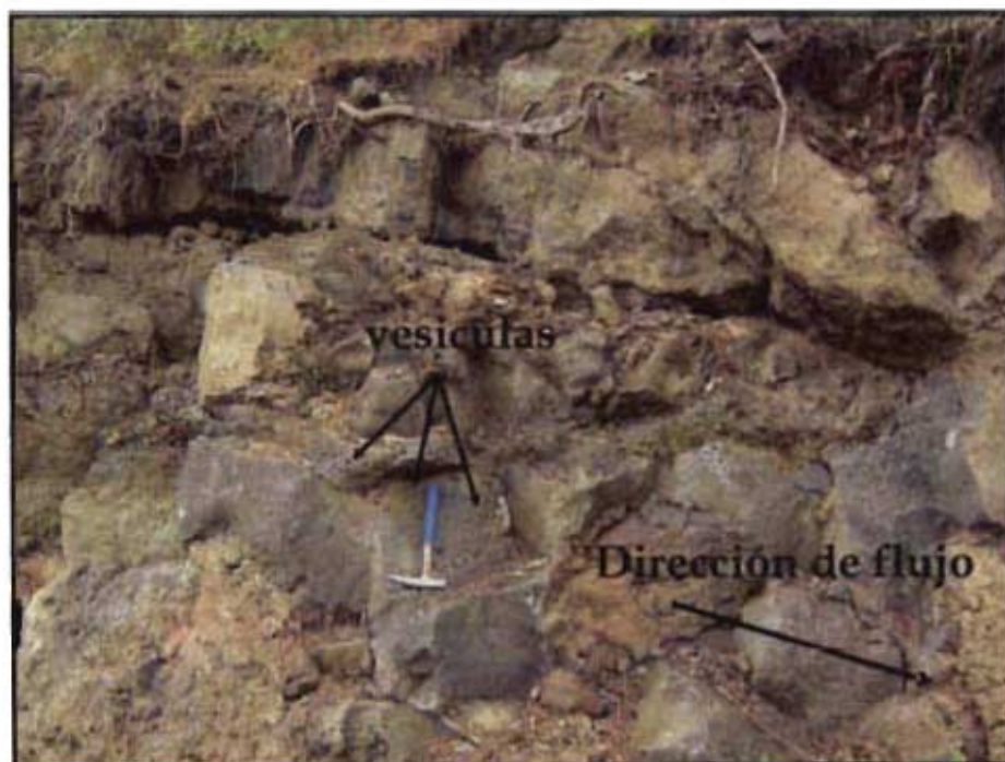
Figura 2.14 Flujos de basalto provenientes del Volcán La Joya. Son de color gris, con fracturas irregulares y contiene vesículas de forma elíptica.
