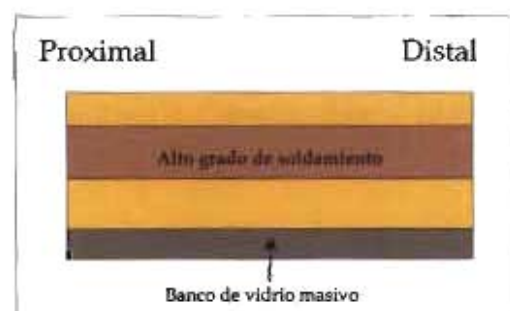
Figura 3.4 Perfiles verticales y laterales esquemáticos de ignimbritas de alto grado. El grado de soldamiento es casi uniforme tanto en sentido vertical como lateral. Es característico un banco de vidrio en la base, que está constituido por vitroclastos intensamente deformados y compactados. (Tomada de Francis, 1993).
