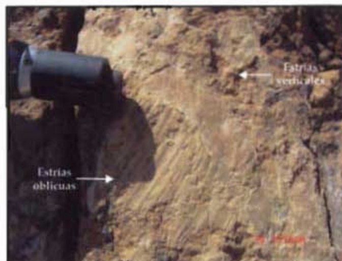
Figura 2.23. Fotografía que muestra las estrías oblicuas cortando a las estrías verticales. Foto tomada sobre el libramiento de Xalapa-Coatepec.
