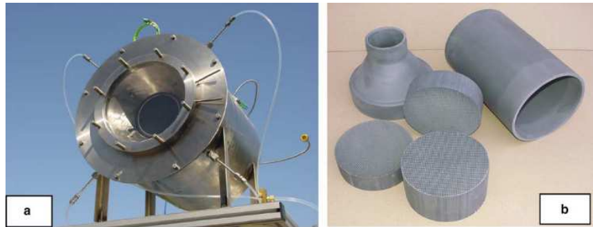
Figura 1.15: (a) Vista frontal del reactor- receptor; (b) soportes de cerámica en forma de panel [50]
