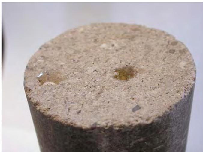
**Figura 27. Prueba visual preliminar de mojabilidad. Núcleo I**
