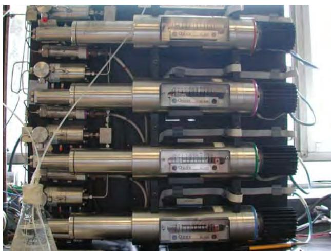
**Figura 35. Bombas Quizix de desplazamiento continuo. IMP**
