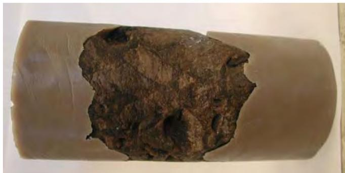
**Figura 22. Núcleo Abk 7 conformado a una forma regular.**
