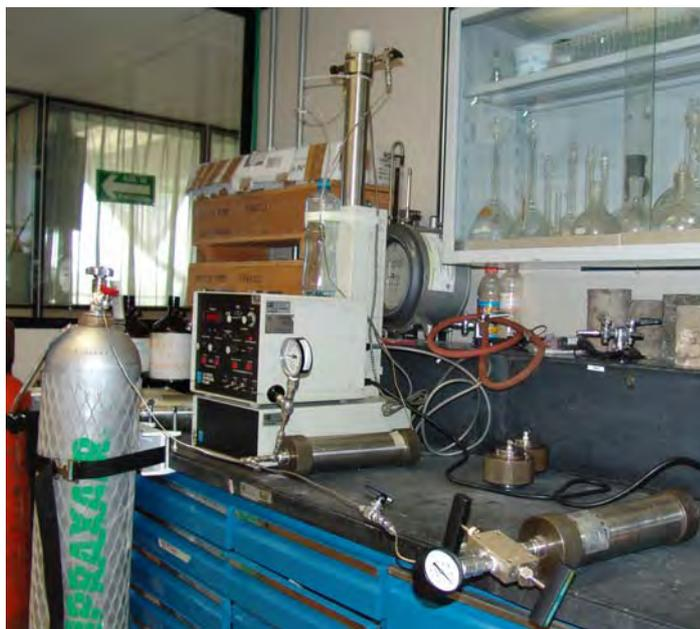
**Figura 46. Foto del arreglo del traspaso del gas.**
