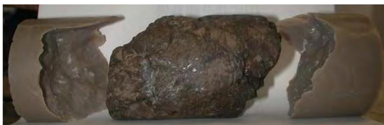
**Figura 21. Núcleo Abk 7 con sus tapas de resina**
