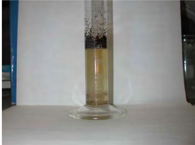
**Figura 79. Fluidos desplazados por inyección alterna de N<sub>2</sub> y surfactante, segunda fase.**
