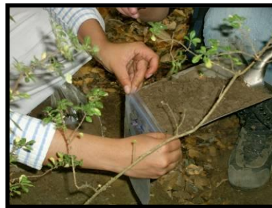
Figura 8. Toma de muestra de suelo de 0 a 20 cm de profundidad
