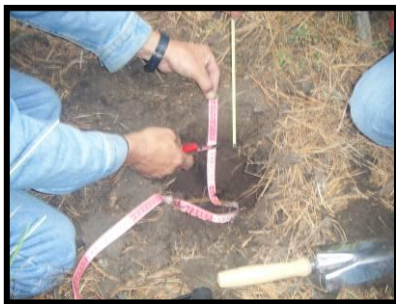
Figura 8. Toma de muestra de suelo de 0 a 20 cm de profundidad
