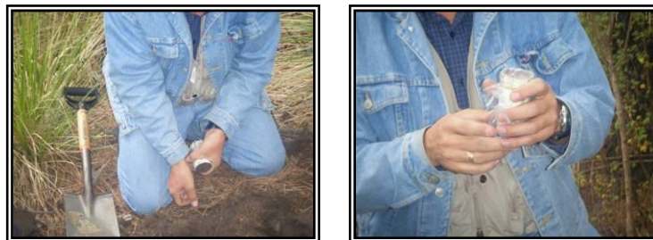
Figura 13. Toma de muestra de suelo con cilindro.
