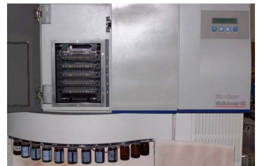
Fig. 16b Equipo abierto mostrando las 8 torres con 7 pisos y el área de reactivos
