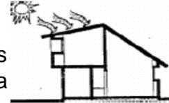
**Muro Eliminador de Calor:** Consiste en un panel de vidrio adosado a un muro asoleado, para que el calor generando en su interior haga la suficiente presión para ser expulsado por la parte superior del panel, arrastrando también el aire caliente adentro de la casa.
