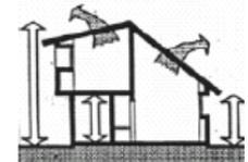
**Celosías y Parteluces Exteriores:** Evitan el asoleamiento directo hacia el interior y por tanto la ganancia de calor. Se deben diseñar para dar suficiente luminosidad natural y bloquear la radiación directa.
