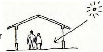
**Aislada o Indirecta:** Se recibe por medio de un elemento ubicado en el exterior, a partir de este se transmite al interior.
