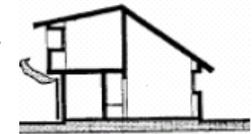
**Efectos del Viento:** La solución tradicional en los lugares calurosos, ha sido la ventilación cruzada. El aire se canaliza de tal manera que atraviesa los espacios habitados, dando la sensación de bienestar y disminuyendo la temperatura.
