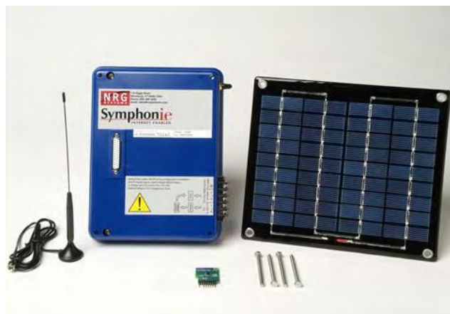
Fig. 3. 6 Sistema de comunicación GPRS con alimentación
