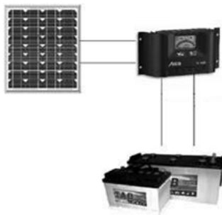
Fig. 2. 10 Sistema fotovoltaico de alimentación
