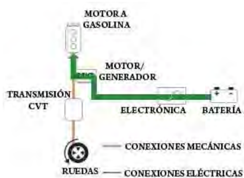
Fig. 1.14 Flujo de Energía a la Puesta en Marcha del Insight
