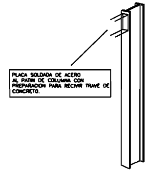
DETALLE DE EMPOTRAMIENTO DE COLUMNA DE ACERO Y TRABE DE CONCRETO.
