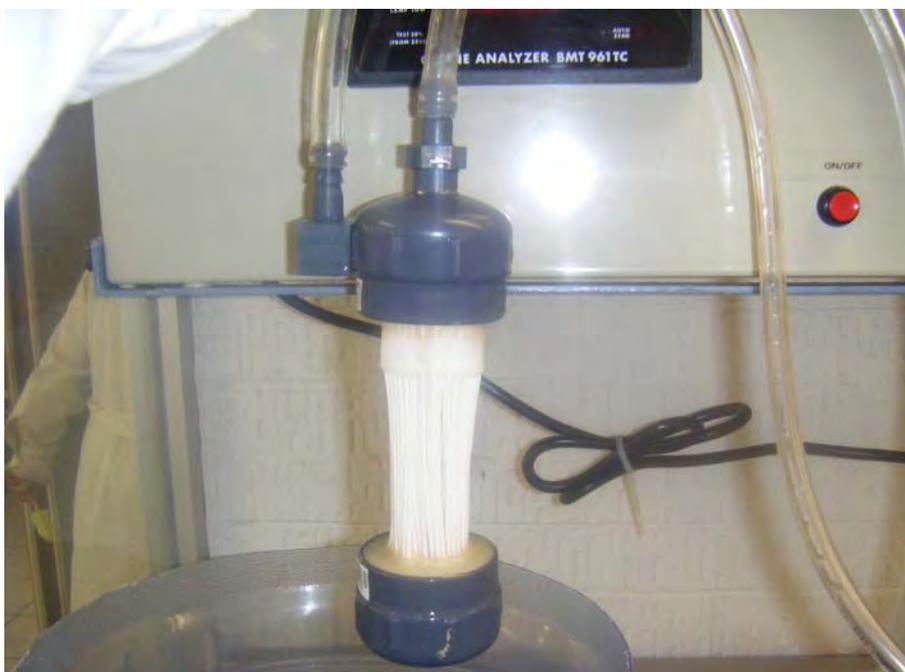
*Figura 3.5. Modulo de ultrafiltración de fibra hueca ZW-1(Zenon®)*
