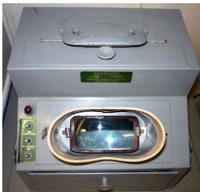
Fluoroscopio (vista de escorzo). Usado para obtener el valor solvente de los recortes.
