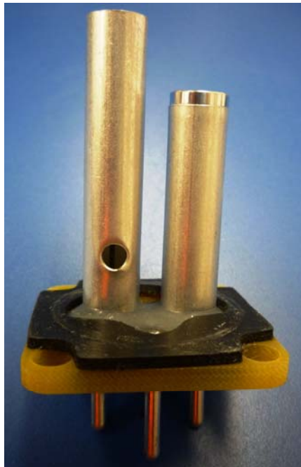
Filamento. Usado para detectar la cantidad de gas total presente en el lodo de perforación.
