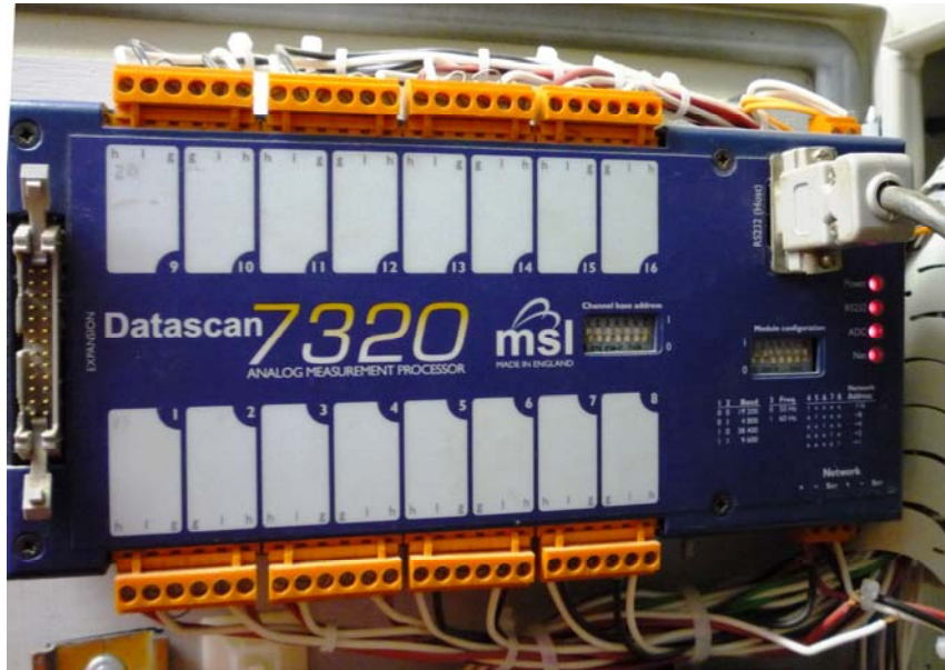
Datascan 7320. Lugar dónde llegan todas las señales de los sensores digitales.
