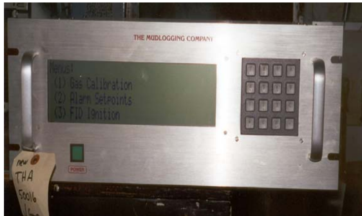
Detector de gas FID – TMC. Detector de alta confiabilidad, dado su amplio rango de detección.
