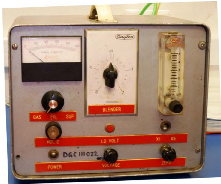
Detector de gas cortes. Usado para detectar la cantidad de contenido en los recortes.
