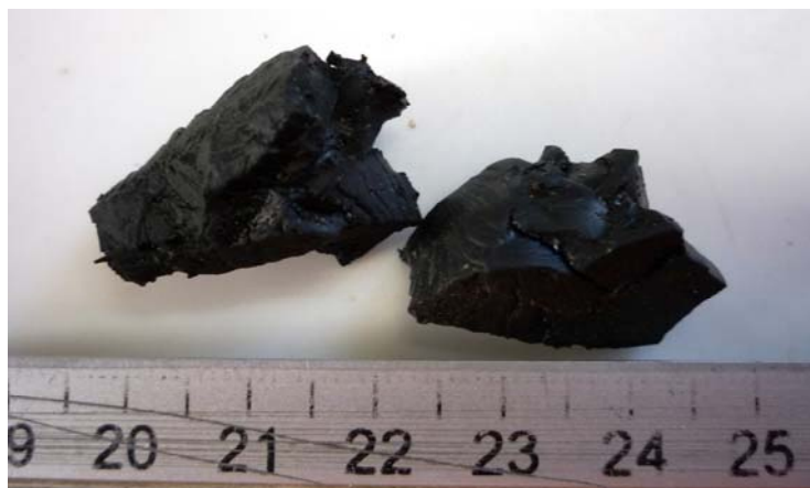
Pedazos de hule del motor de fondo. Falla ocasionada en el motor de fondo por altas temperaturas.
