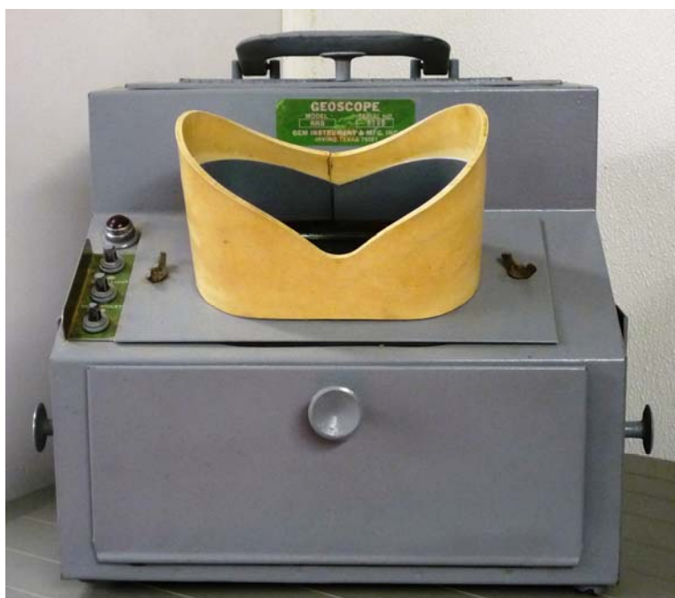
Fluoroscopio (vista de frente). Usado para observar la fluorescencia los recortes.
