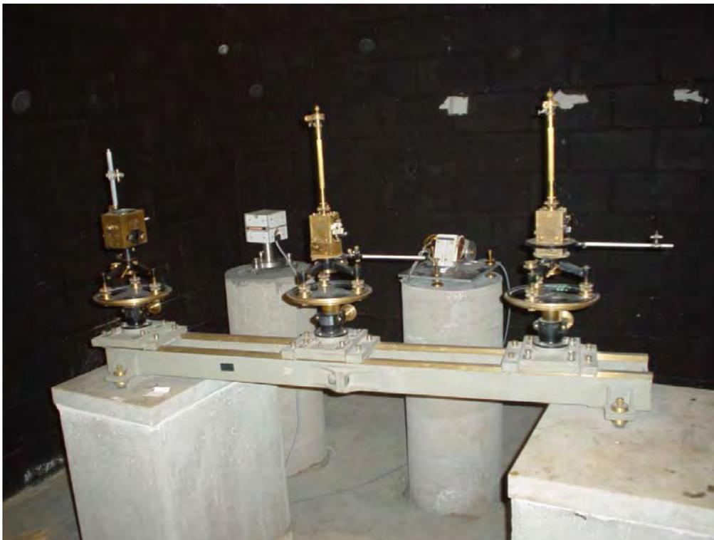
Figura 4.4. Variógrafos en TEO: 1) clásicos Askania en arreglo Eschenhagen en los pilares en cuadrados en línea; 2) digitales DMI y LAMA en los pilares circulares (de izquierda a derecha).
