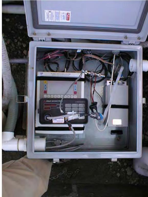
Figura 4.1. Magnetómetro de Precesión Protónica Geometrics G856 instalado en el Volcán Popocatepetl.
