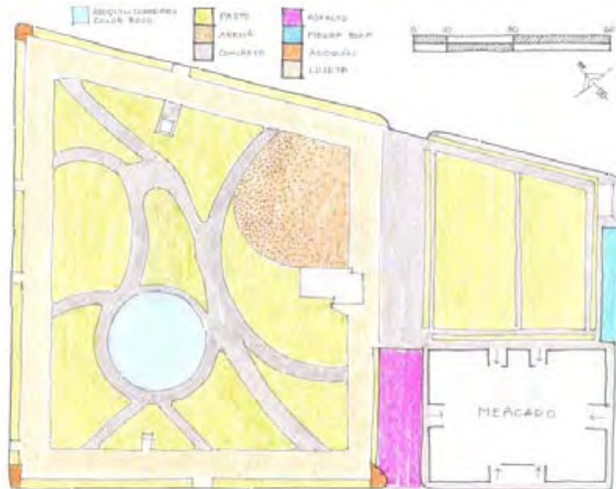
FIGURA 62. Croquis de pavimentos.
