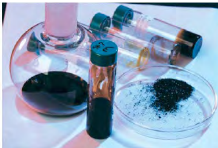
Figura II.1. Separación del petróleo crudo en saturados, aromáticos, resinas y asfaltenos (SARA). En la foto, el frasco contiene la muestra de petróleo pesado calentada. El tubo parado contiene la resina, el plato petri contiene el asfalteno y los otros tubos contienen saturados y aromáticos.
