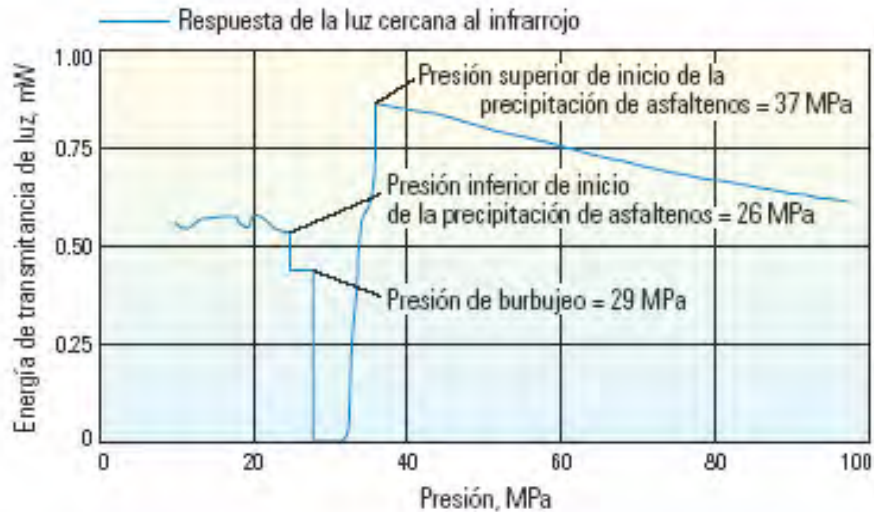
Figura II.4b. Resultados de la técnica de dispersión de la luz, aplicados a la despresurización isotérmica de un petróleo del Golfo de México (Jamaluddin, 2002).
