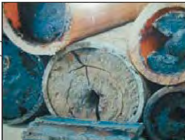
Figura I.12. Proceso de acumulación de sólidos en el pozo.
