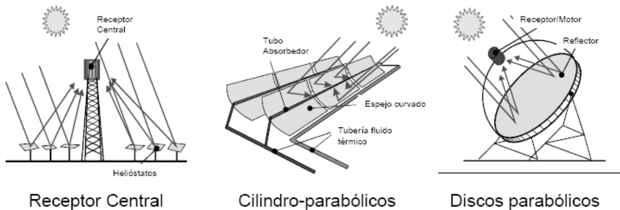
Fig.2 Configuraciones más habituales de los sistemas de concentración solar por reflexión (Romero, 2008)
