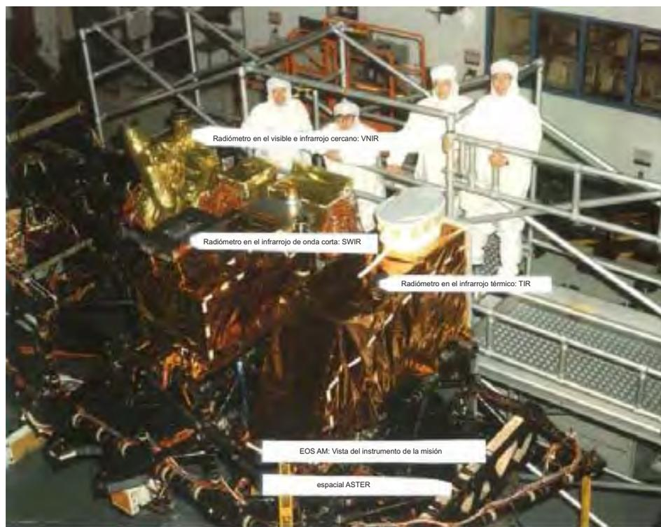
Figura 3.6: Sensor ASTER montando en la plataforma EOS-AM1 (Abrams et al., 2008).
