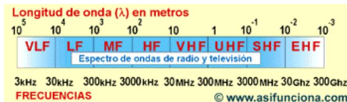
Figura 1.2.4 Espectro Radio Eléctrico
