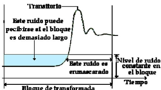
Figura 5.2.31 Transitorio en el final de un bloque de una transformada
