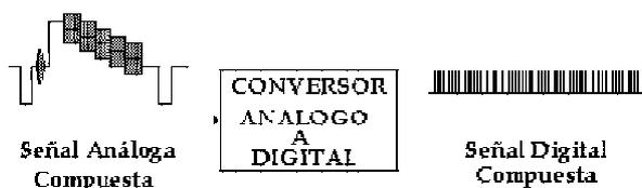
Figura 4.4.11 Codificación de la Señal Compuesta
