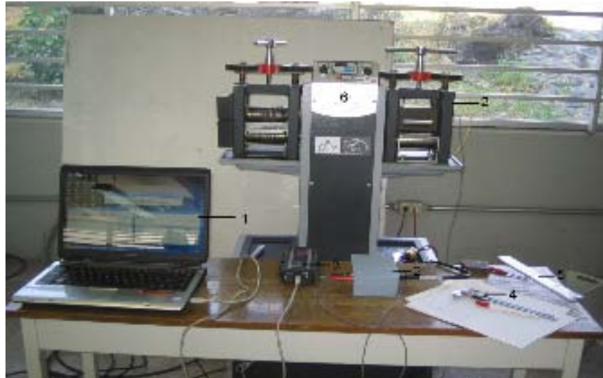
Figura 3.5. Equipo utilizado durante la prueba. 1) Laptop, 2) Celda de carga, 3) Adquisidor de datos, 4) Vernier, 5) Regla, 6) Laminadora.
