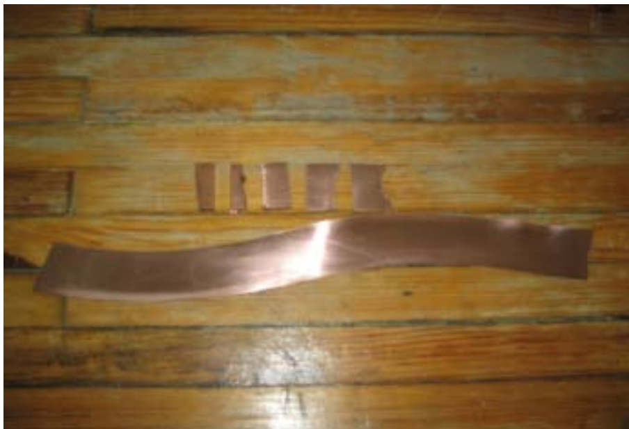
FIGURA 4.2. Probeta deformada por un mal calibrado del equipo después de 5 deformaciones.
