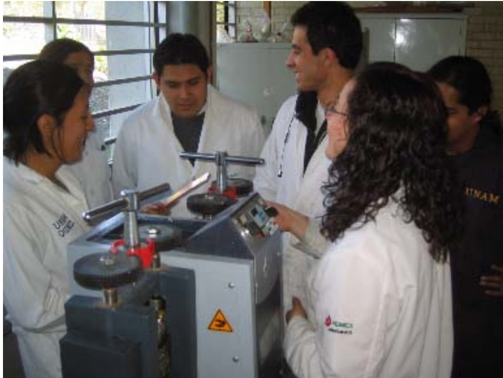
FIGURA 4.12. Alumnos observando los cambios sufridos por una probeta durante el proceso de laminación.
