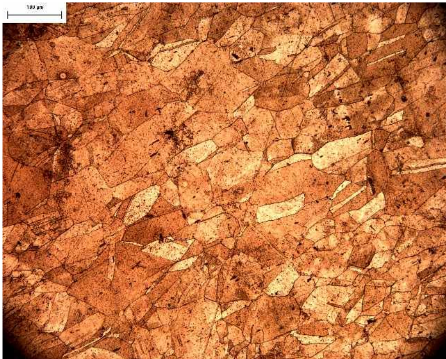
FIGURA 4.17. Cobre con 7.5 mm de espesor. Fotografía tomada a 200X.
