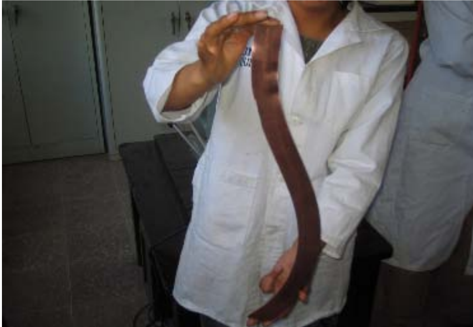
FIGURA 4.13. Probeta laminada con defecto debido a una calibración inadecuada.
