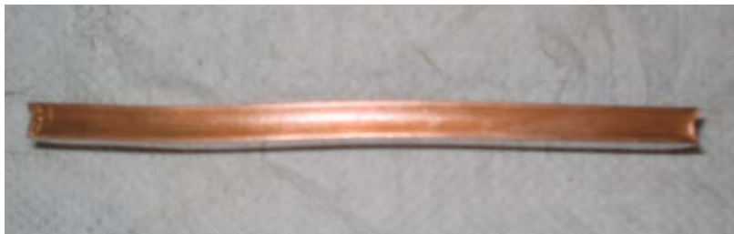
FIGURA 4.5. Defecto en la probeta durante el laminado (vista lateral).
