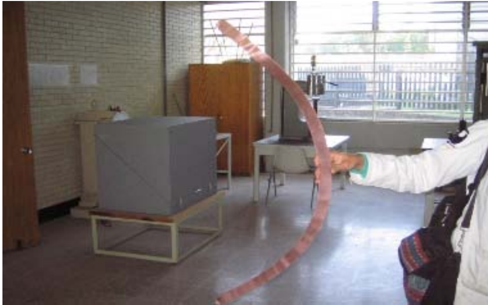
FIGURA 4.14. Curvatura presentada en una probeta al término de la laminación ocasionada por un mal calibrado del equipo.
