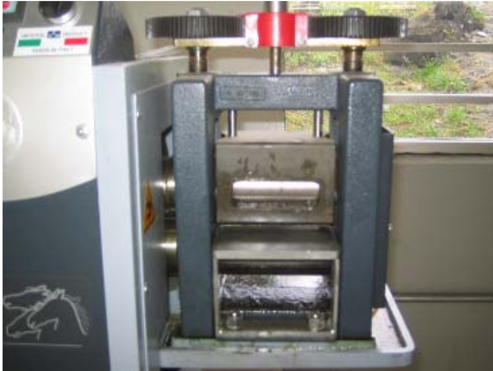
FIGURA 3.2. Rodillos seleccionados para realizar la laminación.
