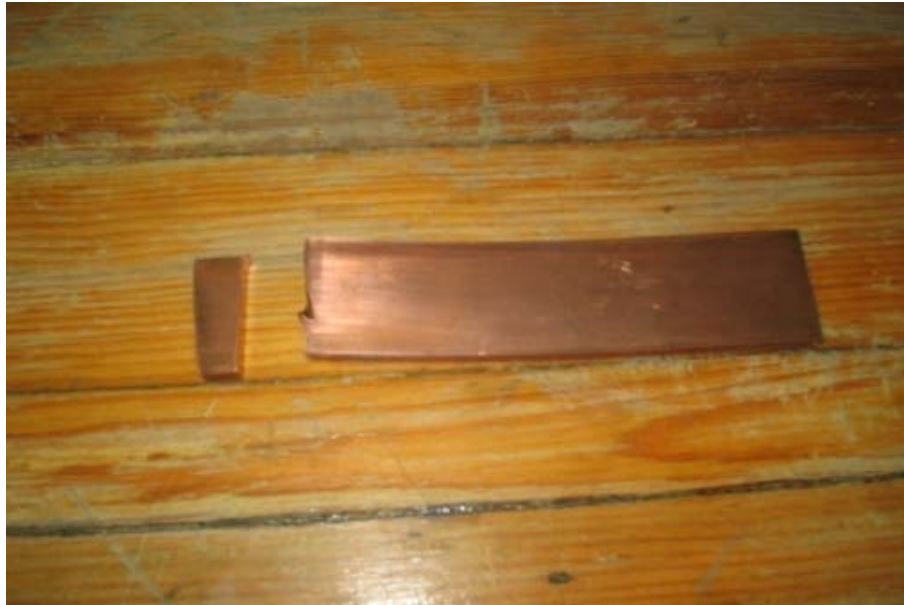
FIGURA 4.1 Probeta deformada por un mal calibrado del equipo.
