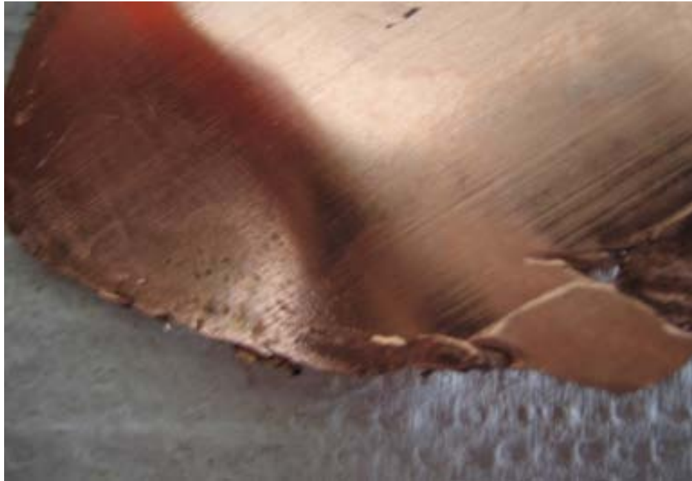
FIGURA 4.6. Defecto en un extremo de la probeta: formación de un borde curvo.
