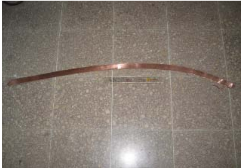
FIGURA 4.3. Probeta deformada al término del proceso por un mal calibrado del equipo.
