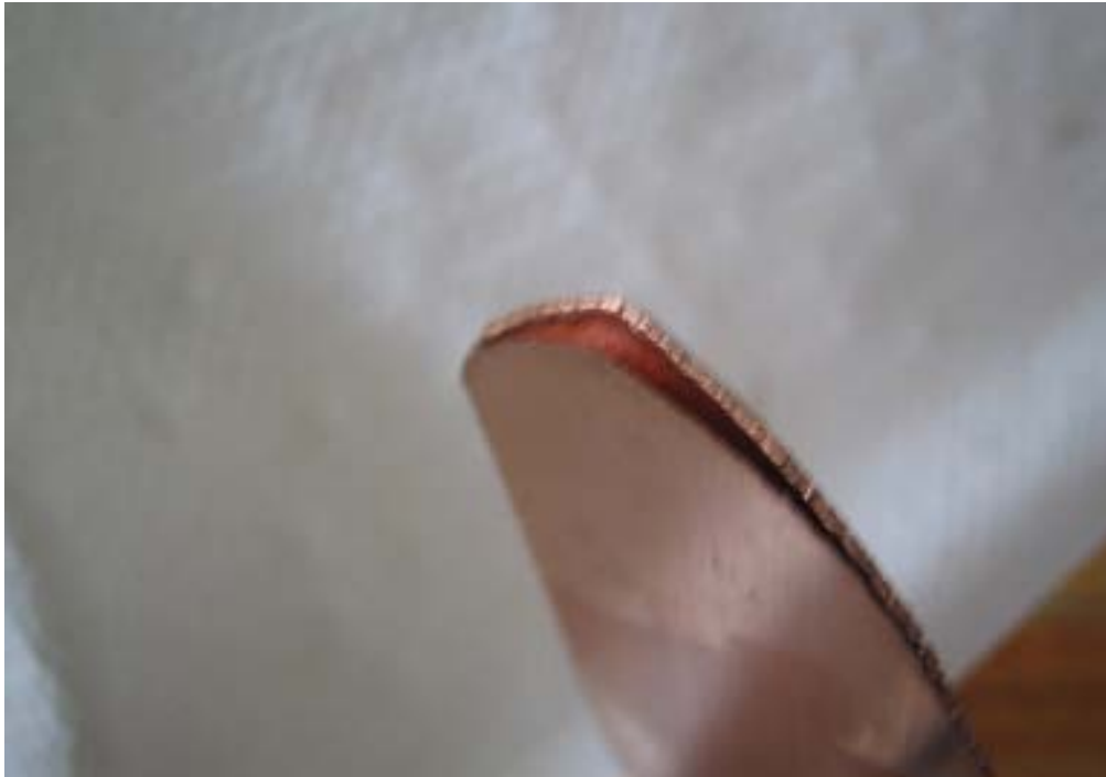
FIGURA 4.8. Defecto en el espesor de la probeta: formación de separación de la lámina, conocido como “boca de cocodrilo”.
