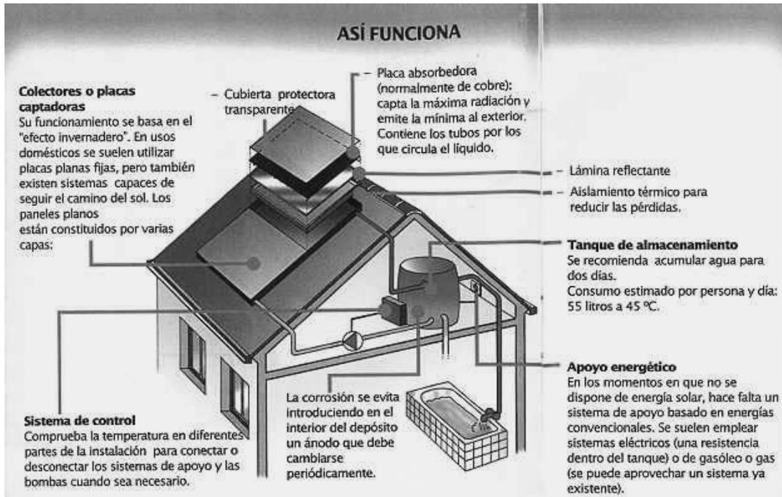
Fig. 3.18 Captación de la energía solar
