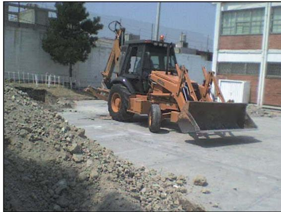
**Fig. IV.2 Retroexcavadora CASE 580 L al momento de las excavaciones**
