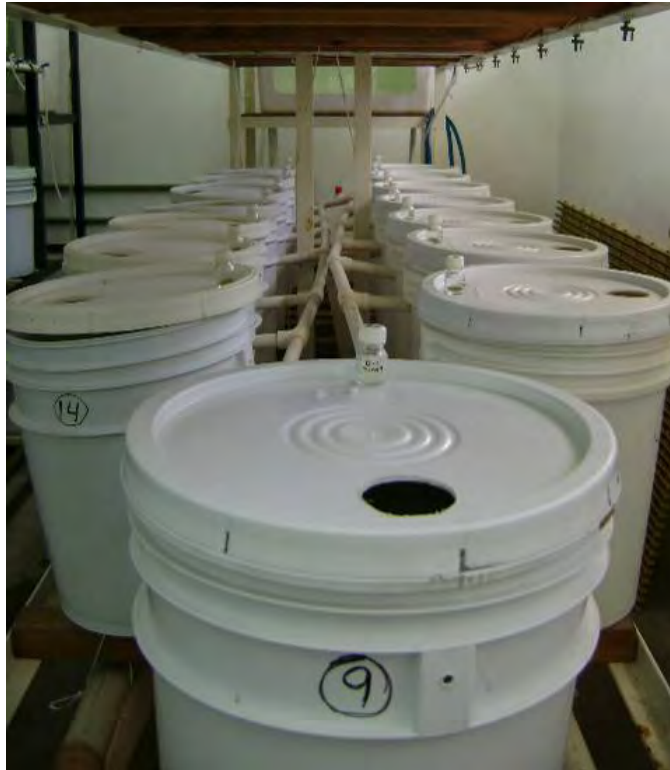
Figura 4. Sistema de recirculación del agua del Laboratorio Húmedo del CINVESTAV, utilizado durante la fase de crianza
