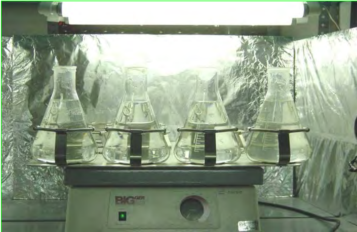
Fig. 2. Diseño de microcosmos. (Nótese su ubicación sobre un agitador orbital y las condiciones de iluminación artificial).
