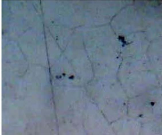
Figura 5.1: Metalografía de la pieza estudiada a 500x vista con ayuda del MEB con un ataque electroquímico con ácido oxálico al 10.
