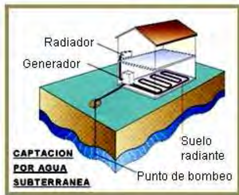
Figura IV.17 Captador vertical abierto (Tomada de Leibar, 2003).
