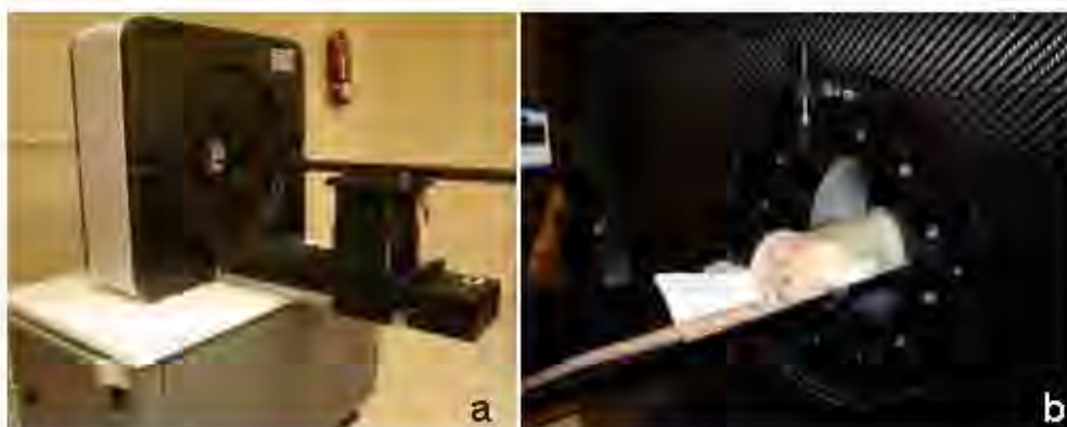
Fig. 1a. Equipo microPET Focus 120 (Concorde, SIEMENS Inc, Knoxville, TN) de la Unidad PET/CT-Ciclotrón, UNAM, 1b. Acercamiento del equipo mostrando la región abdominal de una rata macho colocada en posición supina, durante la adquisición de uno de los estudios.
