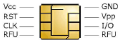
Figura IV.19 Contactos del chip de una tarjeta inteligente
