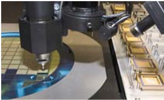
Figura III.43 Montaje de los chips en un marco de plomo
