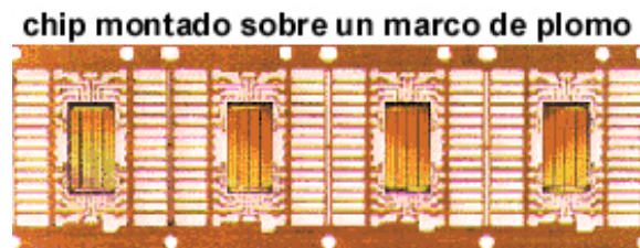
Figura III.43 Montaje de los chips en un marco de plomo
