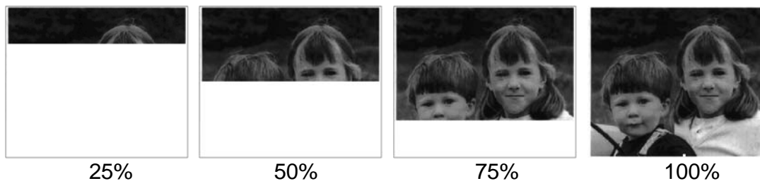
Figura 3.2 Reconstrucción de una imagen utilizando el modo secuencial.
