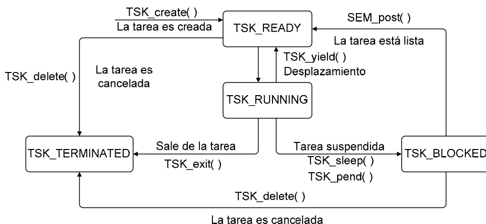
Figura 5.13 Transición de los diferentes estados de ejecución de una tarea.
